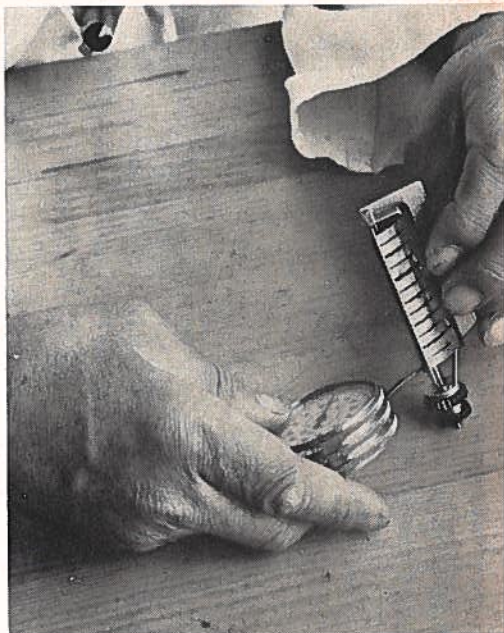
Fig 4 Tijdens het meten van de veerspanning van de borstelveren met de verenweger houdt men de rotor vast door middel van de rotorklem LTG 2151.
